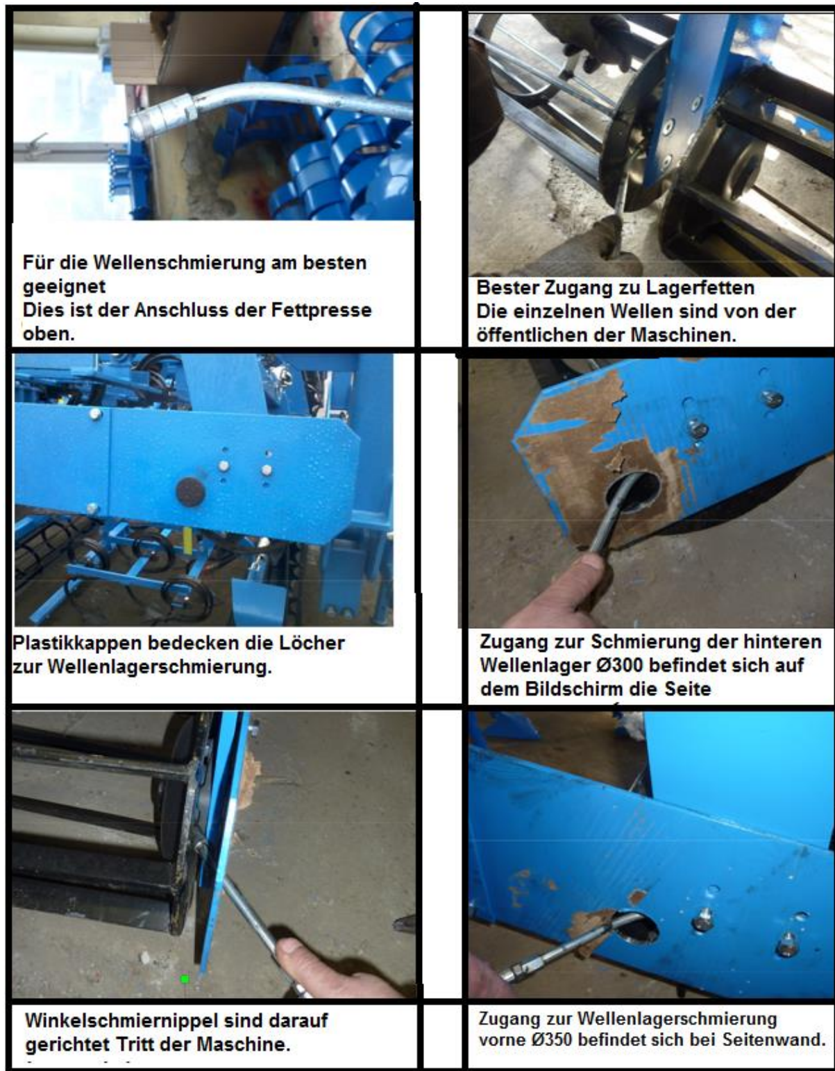
Abb. 18 Schmierung schwer zugänglicher Stellen im SHARP-Saatbettgrubber
